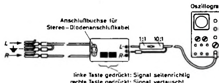
Bild 14. Ein bequem bedienbarer Umpolsschalter läßt sich leicht anfertigen und hilft kostbare Zeit während der Rundfunk-Stereo-Testsendungen sparen
