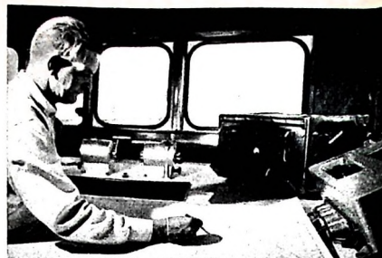
Bild 4. Der „Hi-Fix“-Empfänger im Steuerhaus des Vermessungsschiffes „Nixe Wark“
